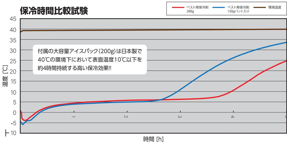
試験条件：業務用冷凍庫(-20℃設定)で冷却したベスト用保冷剤の表面温度を環境温度40℃にて測定。
